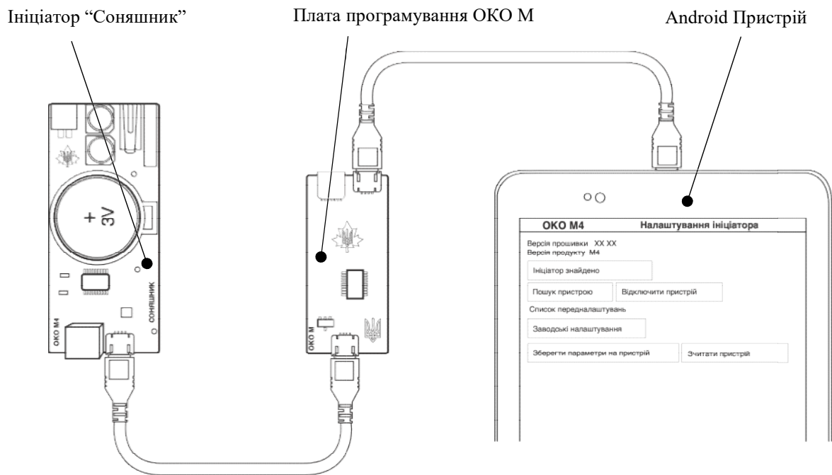
Схема 2. Підключення Android пристрою через плату програмування до плати ініціатора “СОНЯШНИК”
